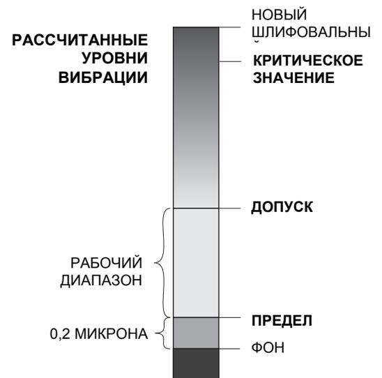
выключении расположенных рядом станков. **Устанавливайте предел балансировки, когда система получает максимальный объем вибрации, передаваемой по полу.**
