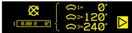
2b) Appliquer des poids, **phase de test** : pendant la phase de test, les poids sont déplacés vers un emplacement où l'effet d'un poids peut être mesuré.
