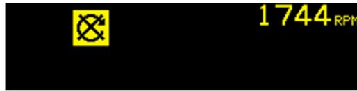
2a) Appliquer des poids, **phase initiale** : une fois la broche arrêtée, cet écran indique à l'opérateur la manière de mettre le poids en place. Pendant la phase initiale, le poids doit être enlevé.
