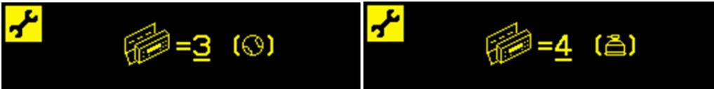
Le premier écran affiché indique que la machine 3 est sélectionnée et est configurée pour le mode d'équilibrage manuel (⌚). Le deuxième écran affiché indique que la machine 4 est sélectionnée et est configurée pour le mode d'équilibrage automatique (⚖️). Si aucun mode d'équilibrage n'est configuré pour un numéro d'identification particulier, alors le ( ) à l'écran est vide. Cela indique qu'un ID est disponible ou n'est pas utilisé.
