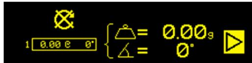
2b) Appliquer des poids, **phase de test** : le poids de test doit être ajouté (
