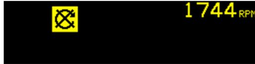
2a) Appliquer des poids, **phase initiale** : une fois la broche arrêtée, cet écran indique à l'opérateur la manière de mettre le poids en place. Pendant la phase initiale, les poids doivent être retirés ou déplacés vers la position nulle illustrée.
