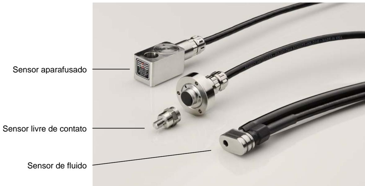
**Sensor aparafusado** – O sensor é anexado através do uso de um parafuso M6 ou ¼" diretamente na estrutura da máquina, perto do ponto de contato entre o rebolo e a peça de trabalho ou o dressador e o disco.
