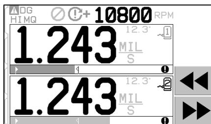
テスト用オモリの配置フェーズは 2 つのステップに分かれています。ステップには 1/2 プレーンのそれぞれに 1 つのオモリの配置が表示されています。スクリーン上には動作中のプレーンが表示され、他のプレーンは薄いグレーで表示されます。指示通りそれぞれのオモリの配置を順に完了して下さい。
