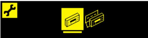
最初のアイコンで 1 台稼働を選択し、2 番目のアイコンで複数台稼働を選択します。複数台稼働では、コントロール・ユニットは、1~8 の ID 番号を使用して、最大 8 台までの設定情報を保存します。これは、コントロール・ユニットが異なる設定要件の機械間を移動するために役立ちます。1 台稼働は、専用の機械に対して使用されます。
