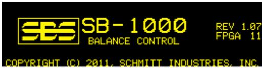
電源オン表示は、電源を入れた直後にのみ 2 秒間表示されます。キャンセル・ボタンを押し続けると、ボタンを解放するまで表示が延長されます。サポート参考用に、この画面の右側に、取付けされたファームウェアのバージョン、その下に FPGA コードのバージョンが表示されます。
