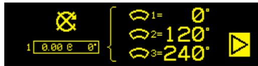
2b) オモリ装着、テスト期 -テスト期では、1 つのオモリの効果を確認するため、オモリの移動位置を指示します。
