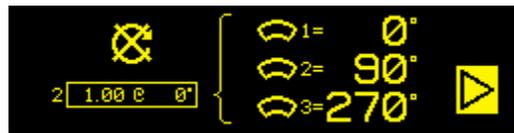
2c) オモリ装着、ソリューション期 -オモリは最小のバランスになる様に指示された位置に変更されます。3 個のオモリの場合と 2 個のオモリの場合の画面が以下に示されています。この期(トリム期)の追加での繰り返しが必要になる場合があります。▶を押すと、この期の次の手順である主軸回転開始画面に進みます。▶記号が点滅します。主軸の回転を開始すると、次の画面に進みます。
