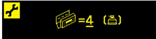
左の画面は、機械 3 が選択され、マニュアル(手動)バランス・モード (M) に設定されていることを表示しています。右の画面は、機械 4 が選択され、自動バランス・モード (A) に設定されていることを表示しています。特定の ID 番号にバランス・モードが設定されていない場合、画面上の( )は空欄となります。これは利用可能な ID または未使用 ID を示しています。
